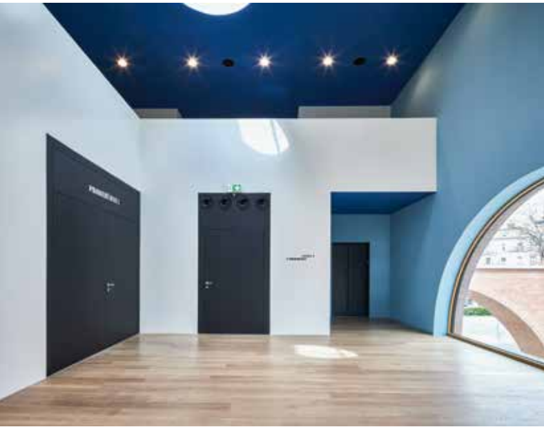
通风口创造性地集成到了侧壁的上方。
